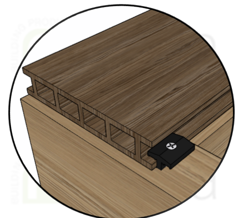
VISTA ISOMÉTRICA RESYSTA DECKING
