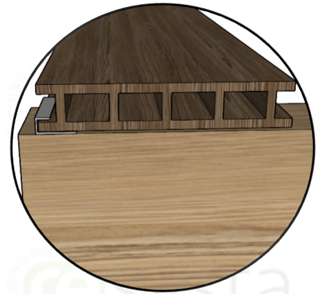
VISTA ISOMÉTRICA RESYSTA DECKING
